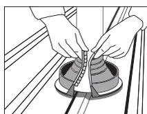
Abraze el ducto con la parte superior del cono, aplique el broche en posición hacia abajo y acople los dientes de metal en las cavidades opuestas.
